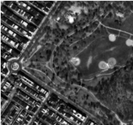
La escala de la aerofoto de arriba es 1:24,000. Es decir, un centímetro de la foto es igual a 24,000 centímetros—ó 240 metros— en el terreno. La aerofoto de la derecha es una sección de la otra, a escala de 1:12,000. Esta escala mayor muestra más detalles. Obsérvese la aerofoto a mayor escala cuidadosamente. ¿Dónde se localiza esta área en la foto a escala pequeña de arriba?
